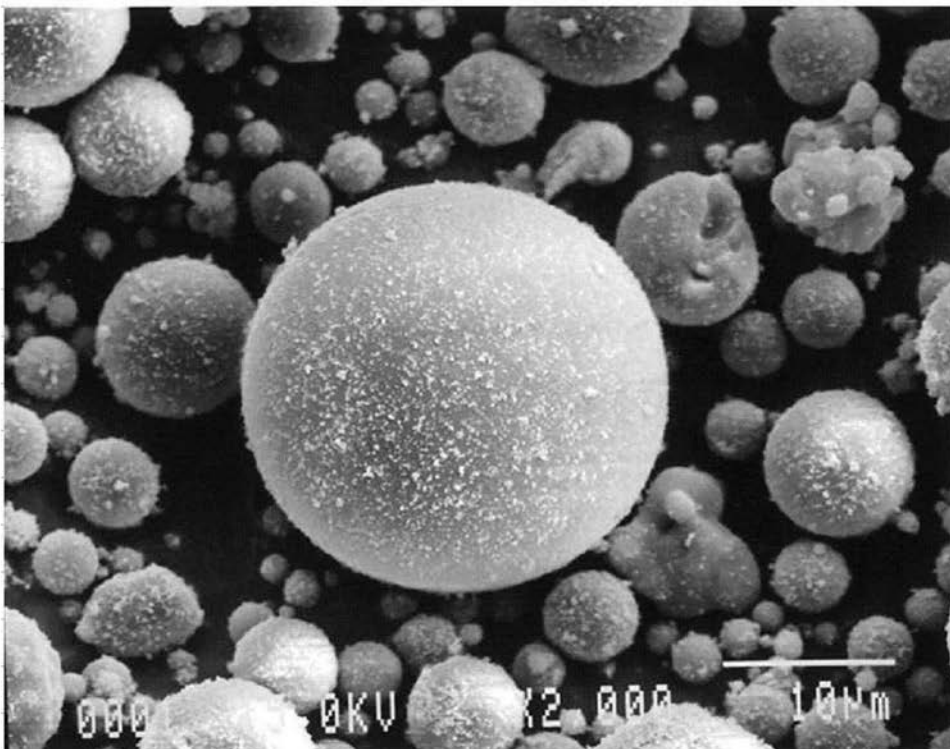
(b) JIS灰 (フライアッシュ) の粒子構造を示す顕微鏡写真
