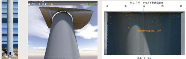
画像解析で劣化範囲(錆、塗装剥げ)を算出し、適切な補修範囲の設定が可能です。
