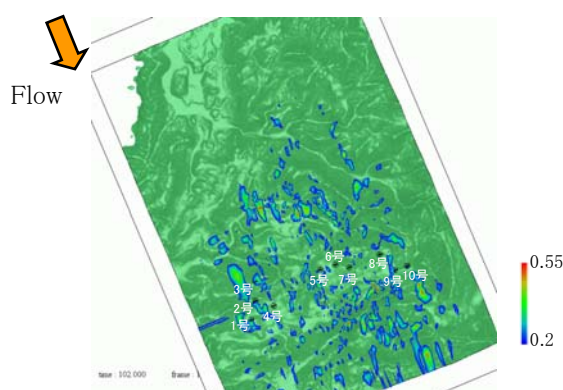
図7 風車ハブ高さにおける主流方向変動速度成分の分布
