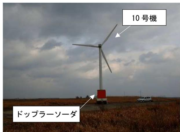
図4 小型ドップラーソーダ(KPA-300)の設置状況
