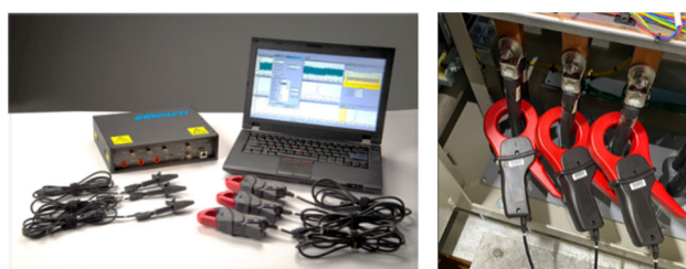
図4 EMPAT TM システム一式と電流測定の様子
