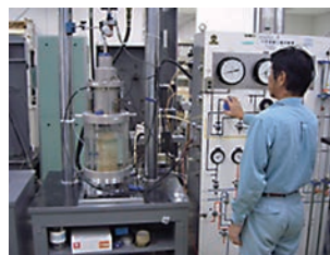
振動三軸圧縮試験装置
